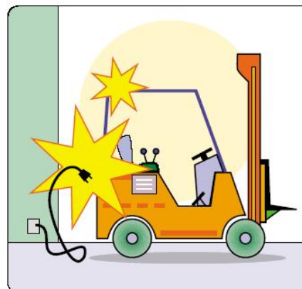
ESPLOSIONE A CAUSA DELL'INNESCO DELL'IDROGENO CHE SI LIBERA IN FASE DI CARICA DELLE BATTERIE
